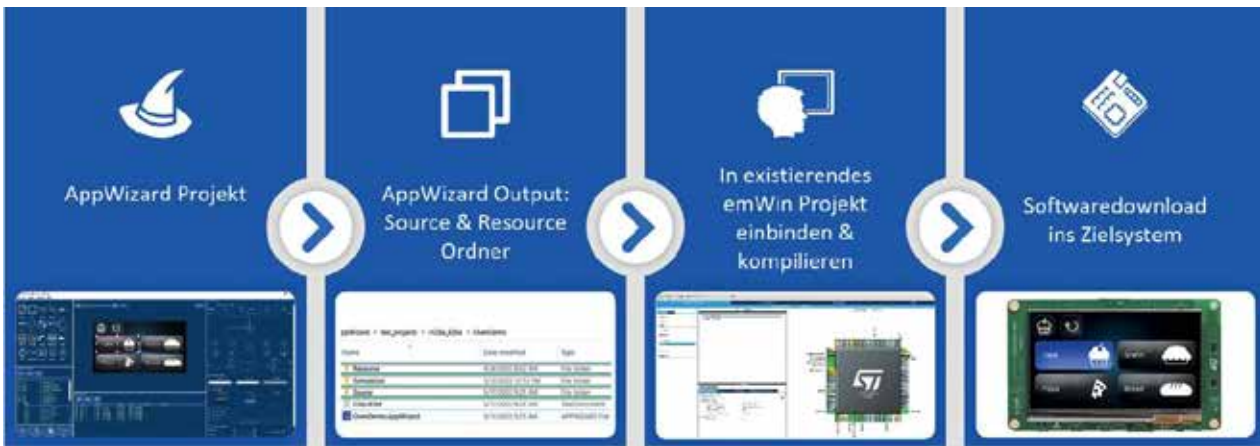
Bild 7. Einbinden von emWin-Code und -Ressourcen in ein bestehendes Projekt. (Bild: Segger Microcontroller)
