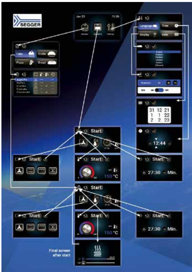
Bild 1. Benutzeroberfläche der Demo für eine Backofensteuerung auf einen Blick. Einige Screens sind der Einfachheit halber nicht dargestellt. (Bild: Segger Microcontroller)
