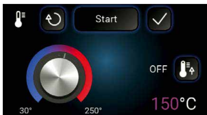
Bild 6. Die Farbe des angezeigten Textes entspricht der aktuell durch den Drehknopf ausgewählten Temperatur. (Bild: Segger Microcontroller)
