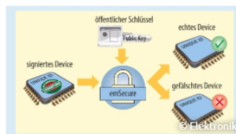
Bild 1. Flasher Secure verwendet für die Authentifizierung emSecure. emSecure ist sowohl als RSA- als auch als ECDSA-Version verfügbar.
