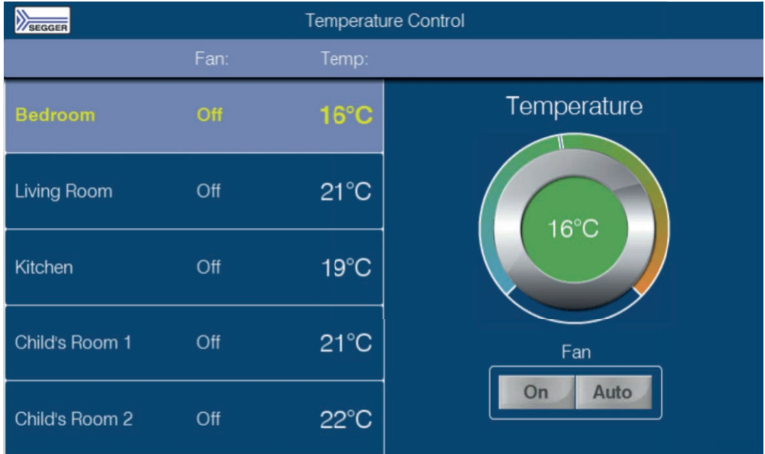
Bild 2 zeigt eine Temperaturstation, die mit emWin und dem AppWizard erstellt wurde, ohne Programmierung.
