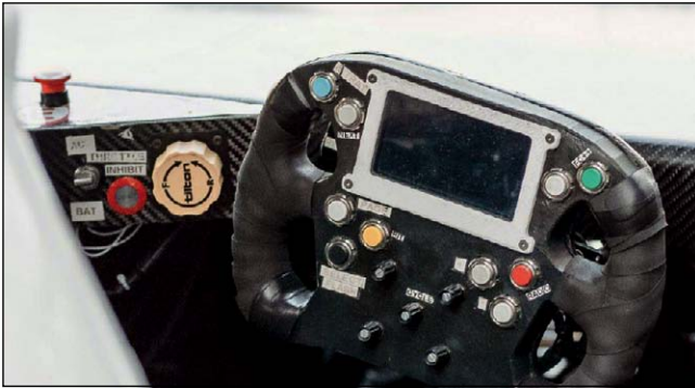
Bild 3. Das Lenkrad besitzt einen eigenen Prozessor, primär um das Display anzusteuern. (Bild: Segger)
