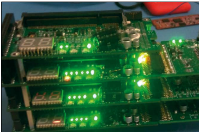
Bild 5. Prototyp des Central Processing Stack (CPS). (Bild: Segger)
